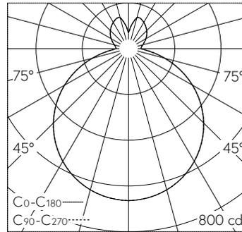
LED 3000 K 28.7 W 2629 lm-h / CIE Flux 44 75 92 78 100 / B32 selon DIN 5040
