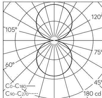
LED 3000 K 10.5 W 674 lm-h / CIE Flux 45 77 94 50 100 / C43 selon DIN 5040
