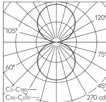
LED 3000 K 15 W 1023 lm-h / CIE Flux 45 77 95 50 100 / C43 selon DIN 5040
