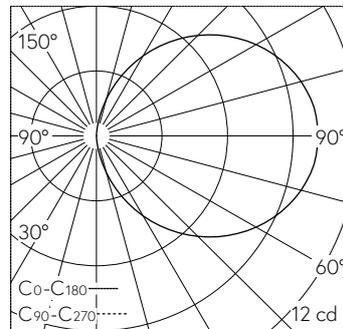
LED 3000 K 2.3 W 31 lm-h / CIE Flux 12 37 66 50 100 / C11 selon DIN 5040
