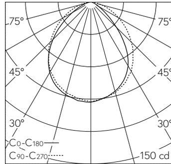
LED 3000 K 2.7 W 198 lm-h / CIE Flux 59 88 98 100 100 / A50 selon DIN 5040
