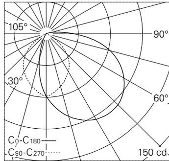
LED 3000 K 3.8 W 188 lm-h / CIE Flux 42 72 90 98 100 / A30 selon DIN 5040
