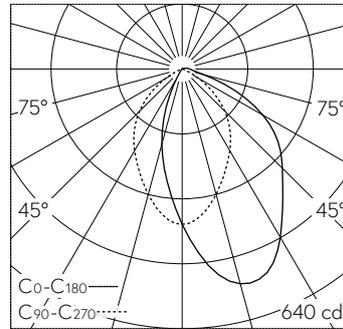
LED 4000 K 9.5 W 662 lm-h / CIE Flux 61 88 98 99 100 / A50 selon DIN 5040
