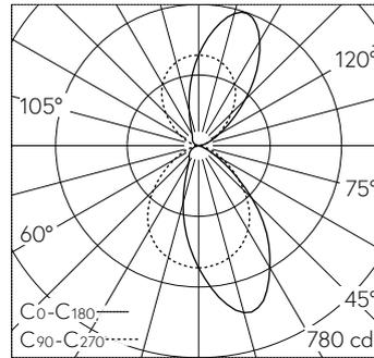
LED 4000 K 17.7 W 1456 lm-h / CIE Flux 64 91 99 55 100 / C64 selon DIN 5040
