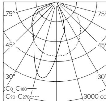
LED 4000 K 19.3 W 2647 lm-h / CIE Flux 59 88 100 100 100 / A50 selon DIN 5040
