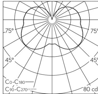
LED 4000 K 3.9 W 401 lm-h 268°/268° / CIE Flux 23 51 76 61 100 / B11 selon DIN 50...
