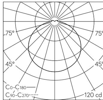
LED 4000 K 3.8 W 300 lm-h 124°/124° / CIE Flux 42 73 92 94 100 / A31 selon DIN 5...
