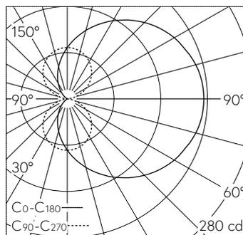
LED 3000 K 10 W 838 lm-h / CIE Flux 28 53 76 50 100 / C22 selon DIN 5040
