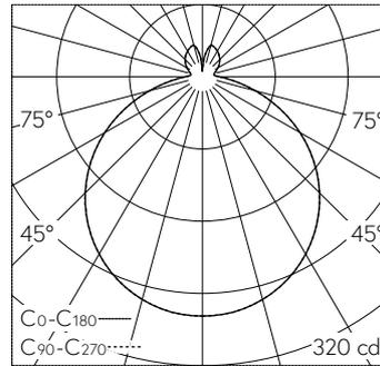
LED 3000 K 10 W 942 lm-h / CIE Flux 45 76 93 86 100 / B43 selon DIN 5040
