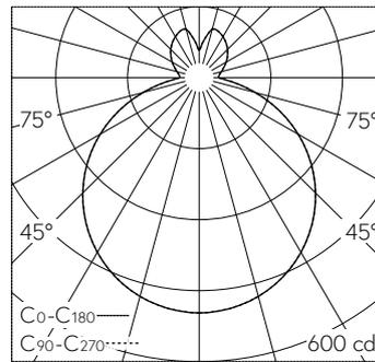
LED 3000 K 19.6 W 1972 lm-h / CIE Flux 44 75 92 78 100 / B42 selon DIN 5040
