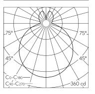
LED 3000 K 13.3 W 1256 lm-h / CIE Flux 43 73 91 77 100 / B32 selon DIN 5040
