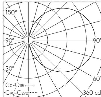
LED 3000 K 9.8 W 798 lm-h / CIE Flux 13 37 66 50 100 / C11 selon DIN 5040
