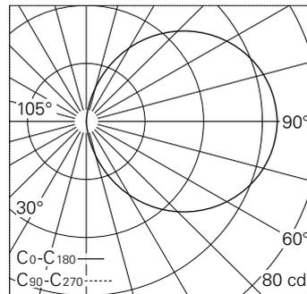
LED 3000 K 2.9 W 153 lm-h / CIE Flux 13 37 66 50 100 / C11 selon DIN 5040
