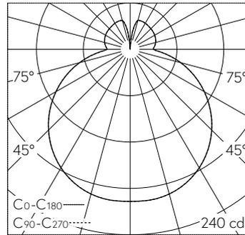
LED 4000 K 9 W 735 lm-h / CIE Flux 40 70 89 76 100 / B32 selon DIN 5040
