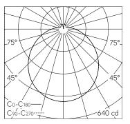
LED 3000 K 15.4 W 2199 lm-h / CIE Flux 42 71 89 88 100 / B31 selon DIN 5040
