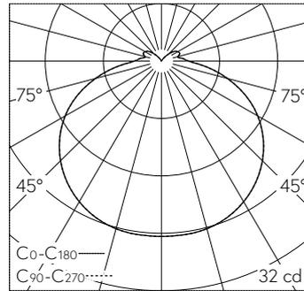
LED 4000 K 1.6 W 97 lm-h / CIE Flux 39 69 89 89 100 / B31 selon DIN 5040
