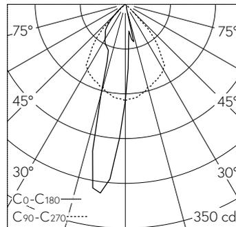
LED 3000 K 6.7 W 150 lm-h / CIE Flux 89 100 100 100 100 / A80 selon DIN 5040
