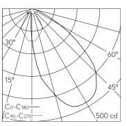
LED 4000 K 4.1 W 350 lm-h / CIE Flux 68 95 100 100 100 / A60 selon DIN 5040
