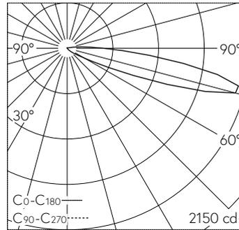
LED 4000 K 15 W 857 lm-h / CIE Flux 0 4 38 92 100 / A11 selon DIN 5040
