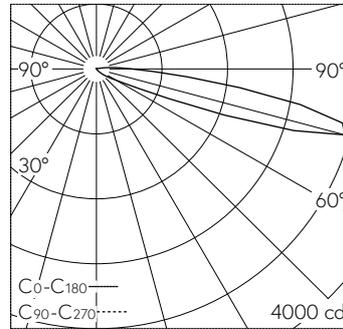
LED 3000 K 24 W 1463 lm-h / CIE Flux 0 3 35 93 100 / A11 selon DIN 5040
