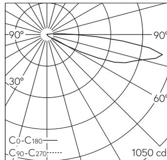
LED 4000 K 8.2 W 481 lm-h / CIE Flux 1 5 40 92 100 / A11 selon DIN 5040
