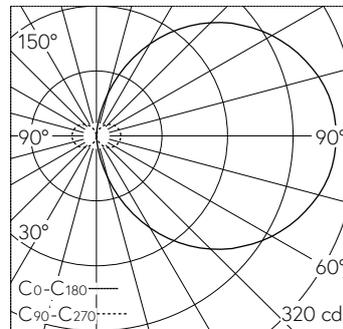
LED 4000 K 11 W 1137 lm-h / CIE Flux 13 37 66 50 100 / C11 selon DIN 5040
