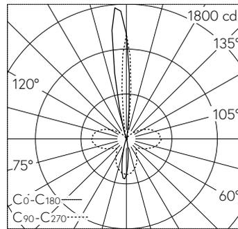
LED 3000 K 19.5 W 714 lm-h / CIE Flux 47 61 79 57 100 / C32 selon DIN 5040
