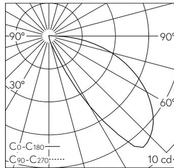
LED 3000 K 2.9 W 10 lm-h / CIE Flux 16 56 86 99 100 / A10 selon DIN 5040
