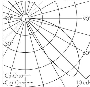
LED 4000 K 2.9 W 10 lm-h / CIE Flux 16 56 86 99 100 / A10 selon DIN 5040
