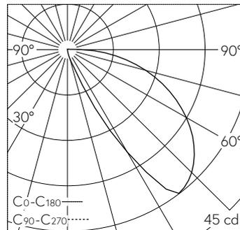
LED 4000 K 4.9 W 41 lm-h / CIE Flux 18 57 86 99 100 / A10 selon DIN 5040
