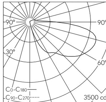
LED 3000 K 44.6 W 3594 lm-h / CIE Flux 13 39 71 88 100 / B11 selon DIN 5040
