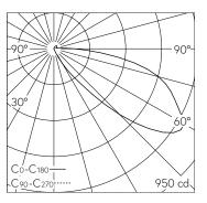
LED 4000 K 7 W 652 lm-h / CIE Flux 8 48 84 94 100 / A12 selon DIN 5040
