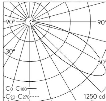
LED 3000 K 10.5 W 951 lm-h / CIE Flux 14 60 91 92 100 / A11 selon DIN 5040
