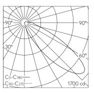
LED 3000 K 17.3 W 1642 lm-h / CIE Flux 24 71 91 94 100 / A21 selon DIN 5040
