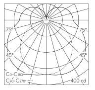
LED 4000 K 14.7 W 1899 lm-h / CIE Flux 36 65 86 74 100 / B31 selon DIN 5040
