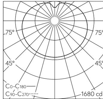
LED 3000 K 50.2 W 8105 lm-h / CIE Flux 26 52 76 57 100 / C22 selon DIN 5040
