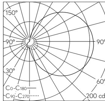
LED 4000 K 6.6 W 588 lm-h / CIE Flux 19 44 71 55 100 / C11 selon DIN 5040
