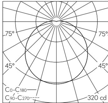
LED 3000 K 9 W 838 lm-h / CIE Flux 42 72 90 96 100 / A30 selon DIN 5040
