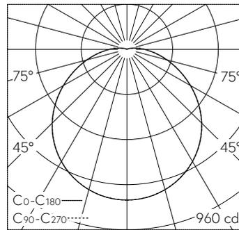
LED 3000 K 26.5 W 2651 lm-h / CIE Flux 43 73 90 96 100 / A30 selon DIN 5040
