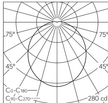
LED 3000 K 8.1 W 712 lm-h / CIE Flux 45 75 92 96 100 / A41 selon DIN 5040
