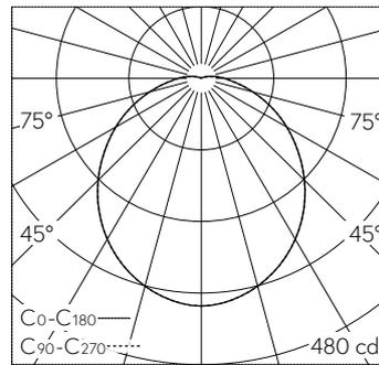
LED 3000 K 14.5 W 1158 lm-h / CIE Flux 45 74 91 96 100 / A40 selon DIN 5040
