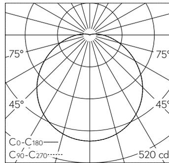
LED 3000 K 14.5 W 1450 lm-h / CIE Flux 43 72 90 96 100 / A30 selon DIN 5040
