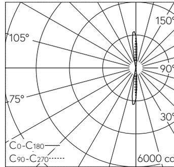
LED 4000 K 5.6 W 176 lm-h / CIE Flux 98 100 100 50 100 / C84 selon DIN 5040
