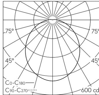
LED 4000 K 14.5 W 1425 lm-h / CIE Flux 46 75 92 97 100 / A40 selon DIN 5040
