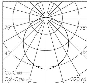
LED 3000 K 9 W 729 lm-h / CIE Flux 46 76 92 96 100 / A40 selon DIN 5040
