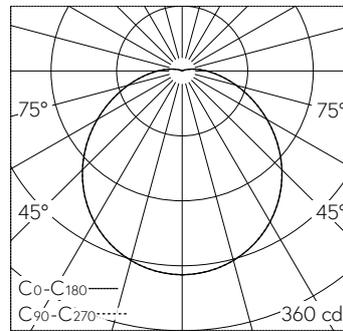
LED 3000 K 8.1 W 992 lm-h / CIE Flux 43 73 90 96 100 / A30 selon DIN 5040
