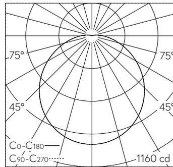
LED 3000 K 26.5 W 3083 lm-h / CIE Flux 44 74 91 97 100 / A30 selon DIN 5040
