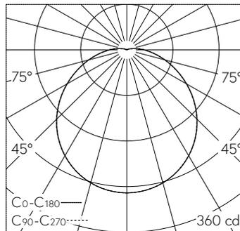
LED 3000 K 9 W 933 lm-h / CIE Flux 43 73 90 96 100 / A30 selon DIN 5040
