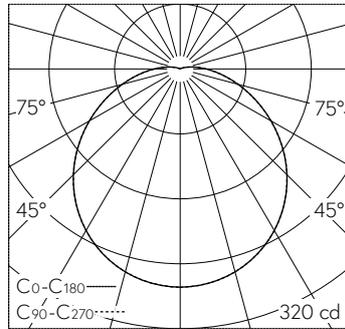
LED 3000 K 9 W 888 lm-h / CIE Flux 43 73 90 96 100 / A30 selon DIN 5040
