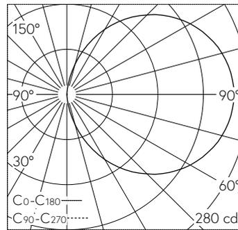
LED 3000 K 11 W 854 lm-h / CIE Flux 13 37 66 50 100 / C11 selon DIN 5040
